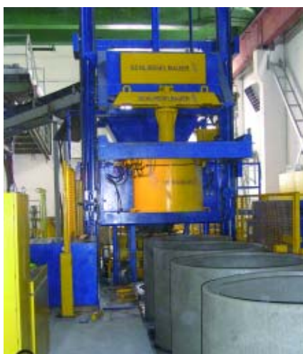
Кольца с фальцем диаметром 700 мм, изготовленные на установке Ringmaster на предприятии JSC Gelgaudiskio Gelzbetonis.
