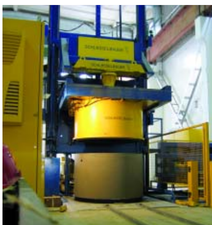
Производство шахтных колец различных диаметров на заводах Kauno Gelzbetonis и Vilniaus Gelzbetoninis Konstrukcijs Gamykla Nr.3.
