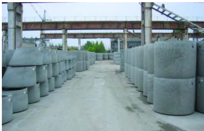
Современные шахтные элементы для инженерного строительства в Литве. На фото – шахтные кольца и конусы на заводе Kaupo Gelzbetonis.
