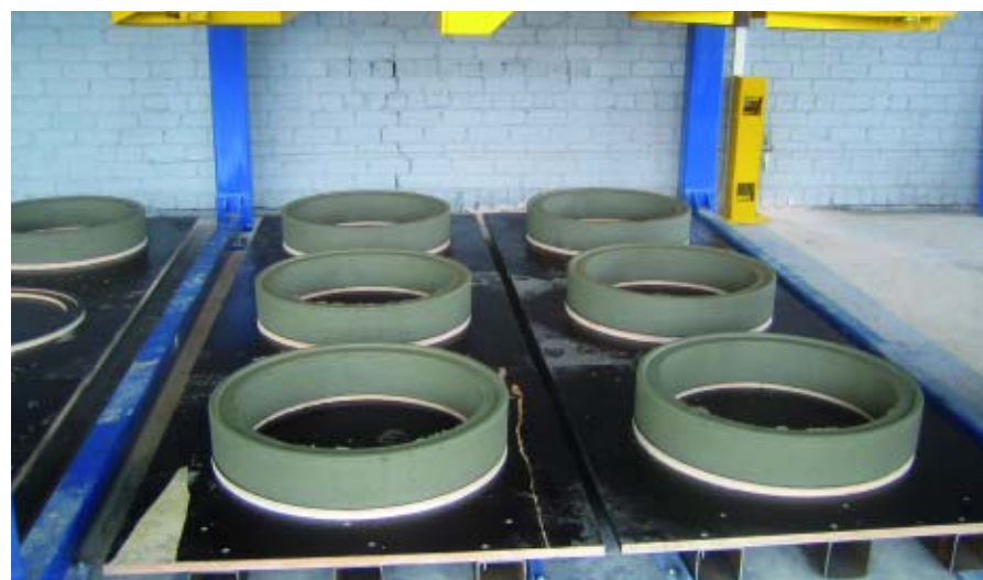
Кольца с фальцем диаметром 700 мм, изготовленные на установке Ringmaster на предприятии JSC Gelgaudiskio Gelzbetonis.
