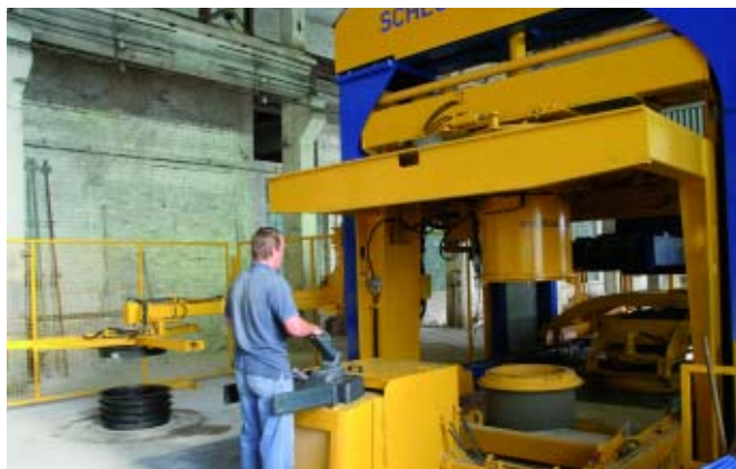
Транспортировка шахтного кольца от установки Magic на заводе Marijampoles Gelzbetonis.
