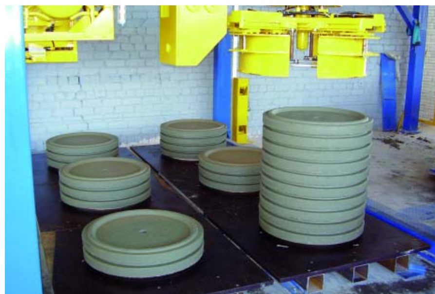
Производство крышек и хандлинг с помощью автоматического штабелеукладчика Ringmaster.
